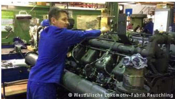
Frank Fessel bei der Generalüberholung eines Diesellaggregates
